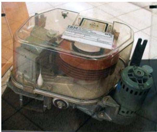
Antiguo disco duro de IBM (modelo 62PC, "Piccolo"), de 64.5 MB, fabricado en 1979
