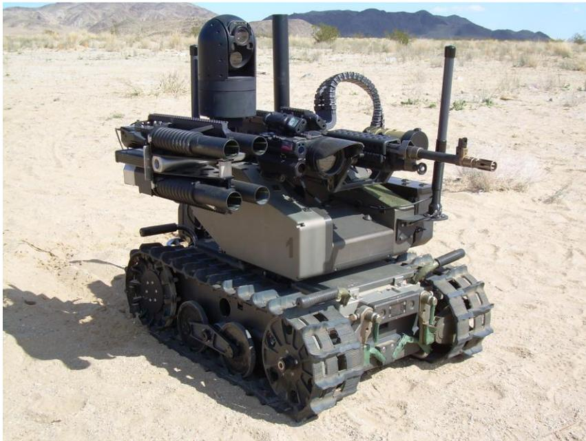
Figura 2.13. Sistema modular robótico armado avanzado (no tripulado pero controlado por un humano a distancia). Fuente: QinetiQ North America bajo [política de uso razonable](#)
