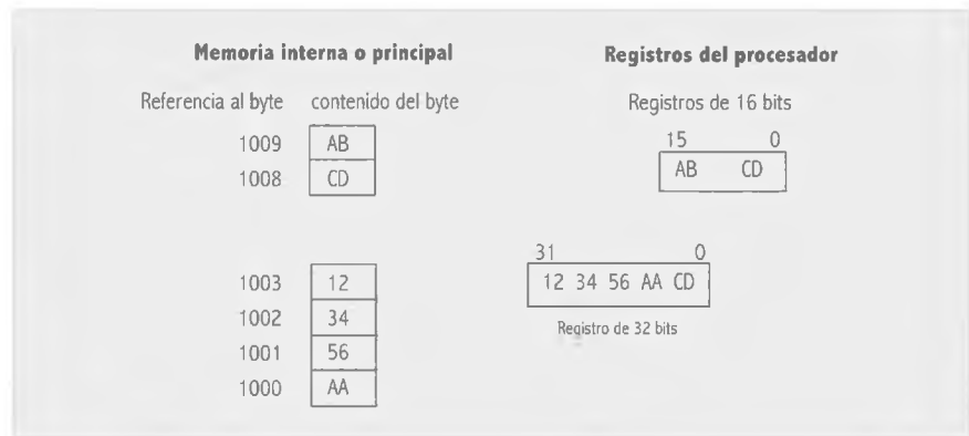
Fig. 9.14. Esquemas de almacenamiento en memoria y almacenamiento en registros para estructura de datos tipo palabra y doble palabra.
