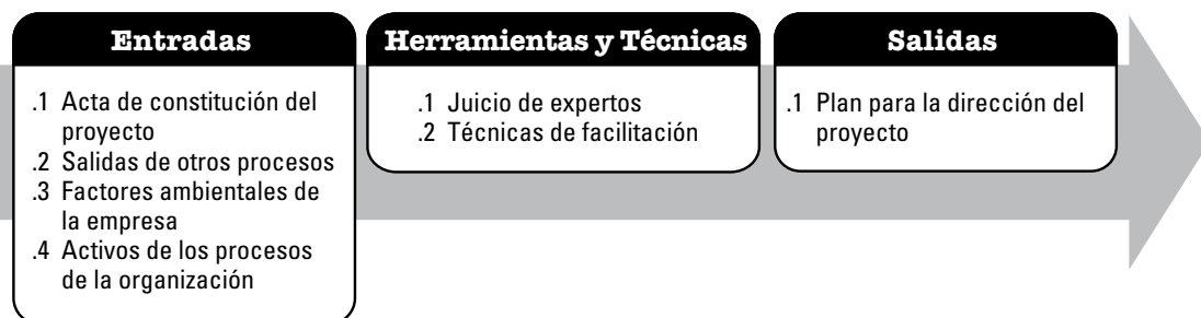
Gráfico 4-4. Desarrollar el Plan para la Dirección del Proyecto: Entradas, Herramientas y Técnicas, y Salidas
